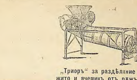
„Триоръ“ за раздѣляние жито и ячменитѣ отъ рѣжъ, нѣклица и отъ сички нечистотии.
