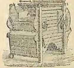
Ветрилица за пречистване храната отъ плѣвата.
