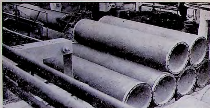
Цех за центрофугални тръби Цех центрифугалних труб
