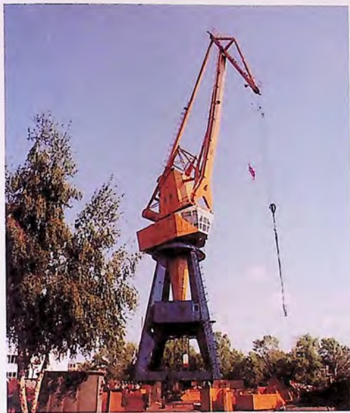
15-тонен портален монтажен кран.
