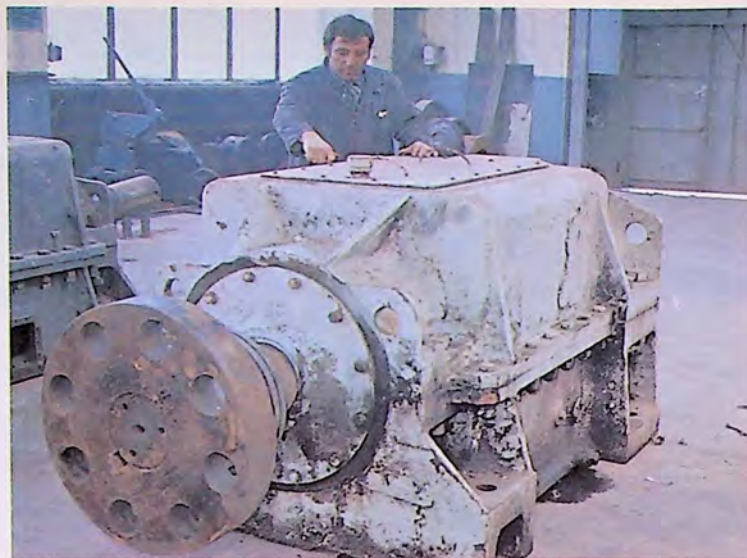
Ремонт при заводски условия на лагерни блокове за мелещи вентилатори
